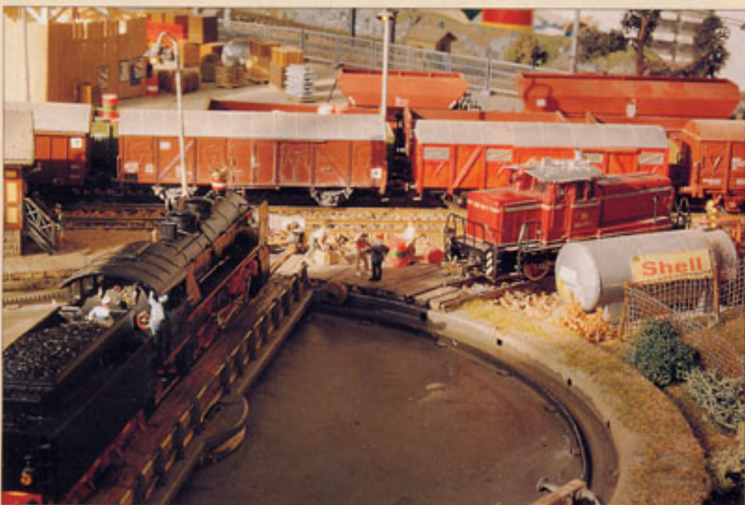
Actividad en el depósito: una locomotora de maniobras toma gasoil, mientras en el puente giratorio una locomotora invierte el sentido de marcha.
